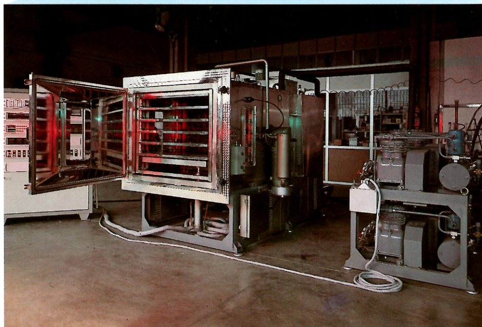
Impianto di liofilizzazione per prodotti con solventi Freeze dryer for products with solvent
